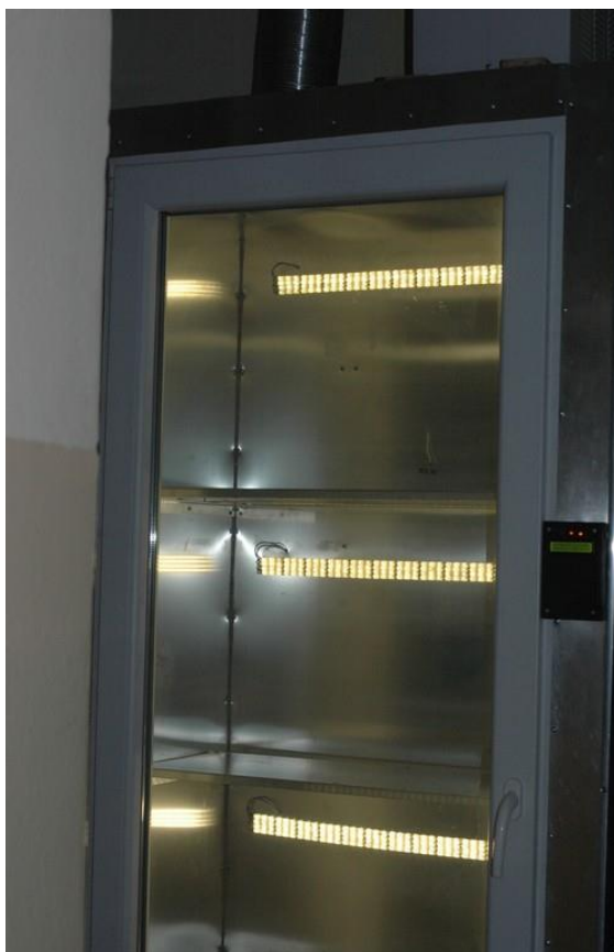
Fot. 2 Komora wzrostowa w Pracowni Fizjologii Roślin i Entomologii, Katedry Bioinżynierii Źródło: fotografie autora.
