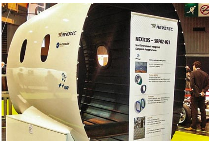
Segment kadłuba samolotu wykonany z włókien węglowych
