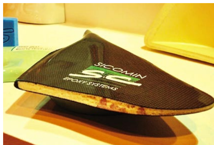
Przekładkowa konstrukcja wypełniona pianką PU
